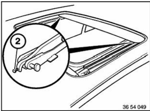
Einstellhebel mit Sicherungsschraube:
