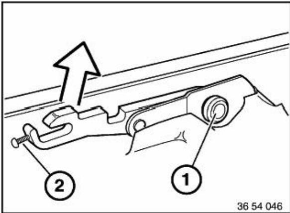
Schrauben (1) erneuern (Mikroverkapselung) oder alte Schrauben mit Loctite 270 (Bezugsnachweis BMW Teiledienst) einsetzen.
