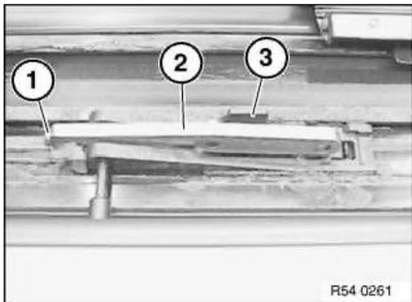
Einstellhebel mit Sicherungsschraube:
