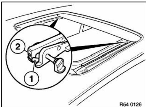
Einstellhebel ohne Sicherungsschraube:
