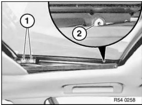
Schrauben (1) und (2) mit Spezialwerkzeug 00 2 130 lösen.
